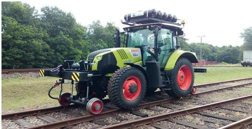
Fot.: Ciągnik bazowy ARION 610 firmy CLAAS (ciągnik szynowo-drogowy typu C120)
